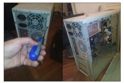
**Βήμα 3°**: Αποσυναρμολογούμε το τροφοδοτικό από το πλαίσιο – σκελετό του H/Y και αποσυνδέουμε τα καλώδια σύνδεσης με τα άλλα εξαρτήματα.
