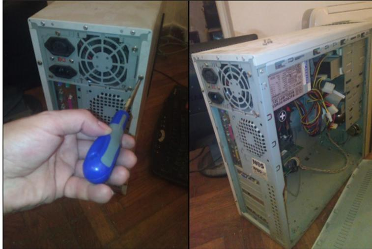
**Βήμα 3°:** Αποσυναρμολογούμε το τροφοδοτικό από το πλαίσιο – σκελετό του Η/Υ και αποσυνδέουμε τα καλώδια σύνδεσης με τα άλλα εξαρτήματα.
